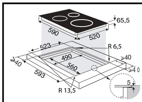
ou au-dessus d'un four encastrable, respectez les dimensions notées sur les illustrations afin d'assurer une sortie d'air suffisante à l'avant. Collez soigneusement le joint d'étanchéité sur tout le pourtour du verre de la table et introduisez la table dans le meuble.
